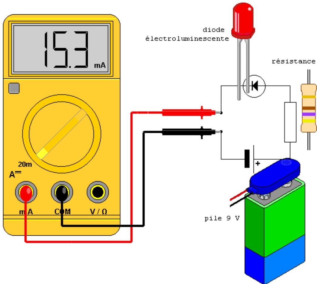
**Ampèremètre** Comment brancher convenablement un ampèremètre dans un circuit électrique.
