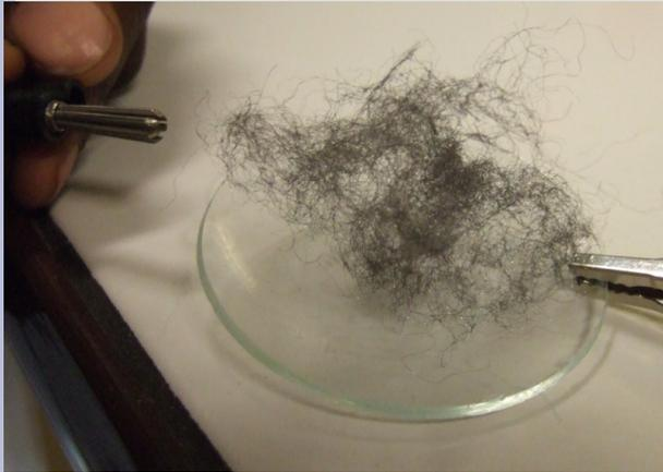
La laine de fer est chauffée par le courant du court-circuit.
