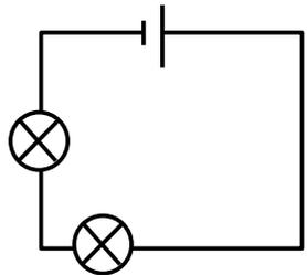
Une fois la partie inutile (doublon) supprimé, le circuit ne comporte qu'une seule boucle. On en déduit qu'il **s'agit d'une circuit en série.**
