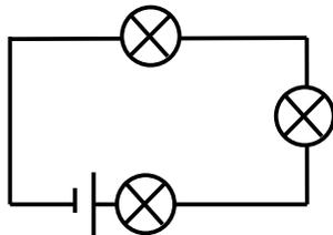
Il est alors facile de constater que le circuit ne présente qu'une seule boucle. On en déduit qu'il **s'agit d'un circuit en série** (car il ne comporte qu'une seule boucle).
