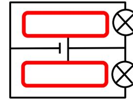
On visualise bien les deux boucles (en rouge sur le schéma). On en déduit qu'il s'agit d'un **circuit en dérivation**.
