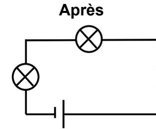
Il est alors facile de constater que le circuit ne présente qu'une seule boucle. On en déduit qu'il **s'agit d'un circuit en série** (car il ne comporte qu'une seule boucle).
