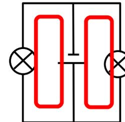
On visualise bien les deux boucles (en rouge sur le schéma). On en déduit qu'il s'agit d'un **circuit en dérivation**.
