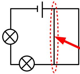
La partie inutile est le fil de connexion supplémentaire qui ne sert à rien. Il est équivalent à celui situé à sa droite. En effet, sur ces deux fils il n'y a aucun dipôle.
