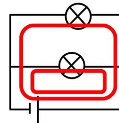
On visualise bien les deux boucles (en rouge sur le schéma). On en déduit qu'il s'agit d'un circuit en dérivation.
